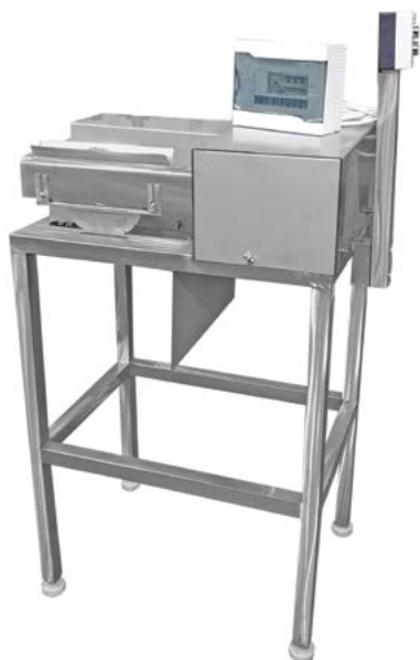
Машина для отрезания головы, хвостового плавника и вскрытия брюшной полости рыбы
