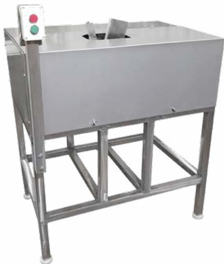
Машина для разрезания тушки рыбы вдоль позвоночного хребта с получением спинки (балык) и брюшка с ребрами (теша)
